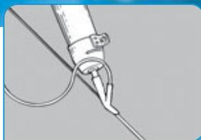
**2.** Quand la colle est entièrement durcie, coupez une rainure le long du joint en utilisant un outil de rainurage standard. L'épaisseur de la rainure doit être de 50-60% l'épaisseur du revêtement de sol et doit avoir une largeur maximale de 3 mm à la surface.
