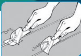
**8.** Laisser ensuite le cordon de soudure refroidir, avant de finir la découpe. Si cela n'est pas respecté, le cordon de soudure va incurvé et piéger la poussière.
